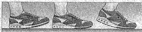
HET TERUGSPRINGEN VAN DE BUISJES IN HUN DOORSPRONKELIJKE VORM GEEFT EXTRA AFZET-ENERGIE.
